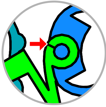
Şekil 4. Birincil kontura bağlı delik konturu.
