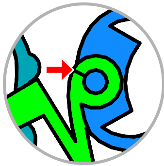
Fig. 4. Kontur av ett hål anslutet till den primära konturen.
