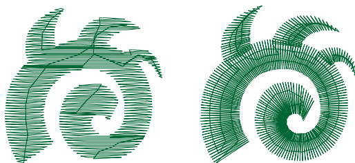
Простая заливка (слева) и заливка авто-колонкой (справа).
