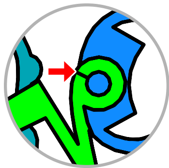
Рис. 4. Контур отверстия, соединенный с основным контуром.
