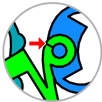
Fig. 4. Contorno de un orificio conectado al contorno principal.
