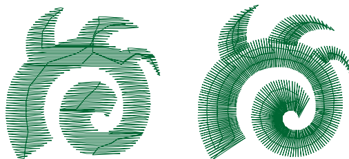
Relleno simple (izquierda) y relleno de columna automática (derecha).
